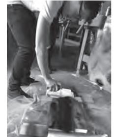
Das Gripp der Vorderseite schneiden und ebenfalls aufkleben. Die Kanten werden sorgfältig abgeschnitten und nochmals geschliffen. Jetzt dürfen die Räder montiert werden.
